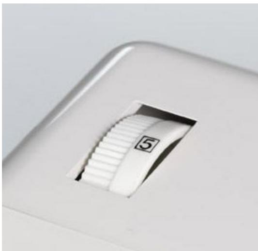
Стандартная установка — в положении 5. При помощи регулятора можно увеличивать и уменьшать давление лапки на ткань в зависимости от типа ткани. Всего шесть положений.
