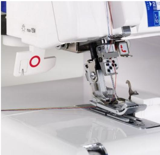
Рычаг защиты игольного стержня в отключенном положении (внизу).
